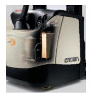
Cargador de batería integrado: compacto, de alta frecuencia y de 30 Amp. Estándar en todos los modelos.
