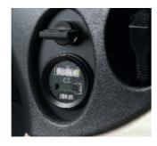
Indicador de descarga de la batería: incluye bloqueo de elevación y
