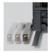
Brazos delanteros regulables: permiten adaptarse a cualquier necesidad cuando se trata de apilar o almacenar la carga, ya que pueden graduarse en cualquier posición entre 865 y 1.270 mm. Estándar en los modelos ST v SX
